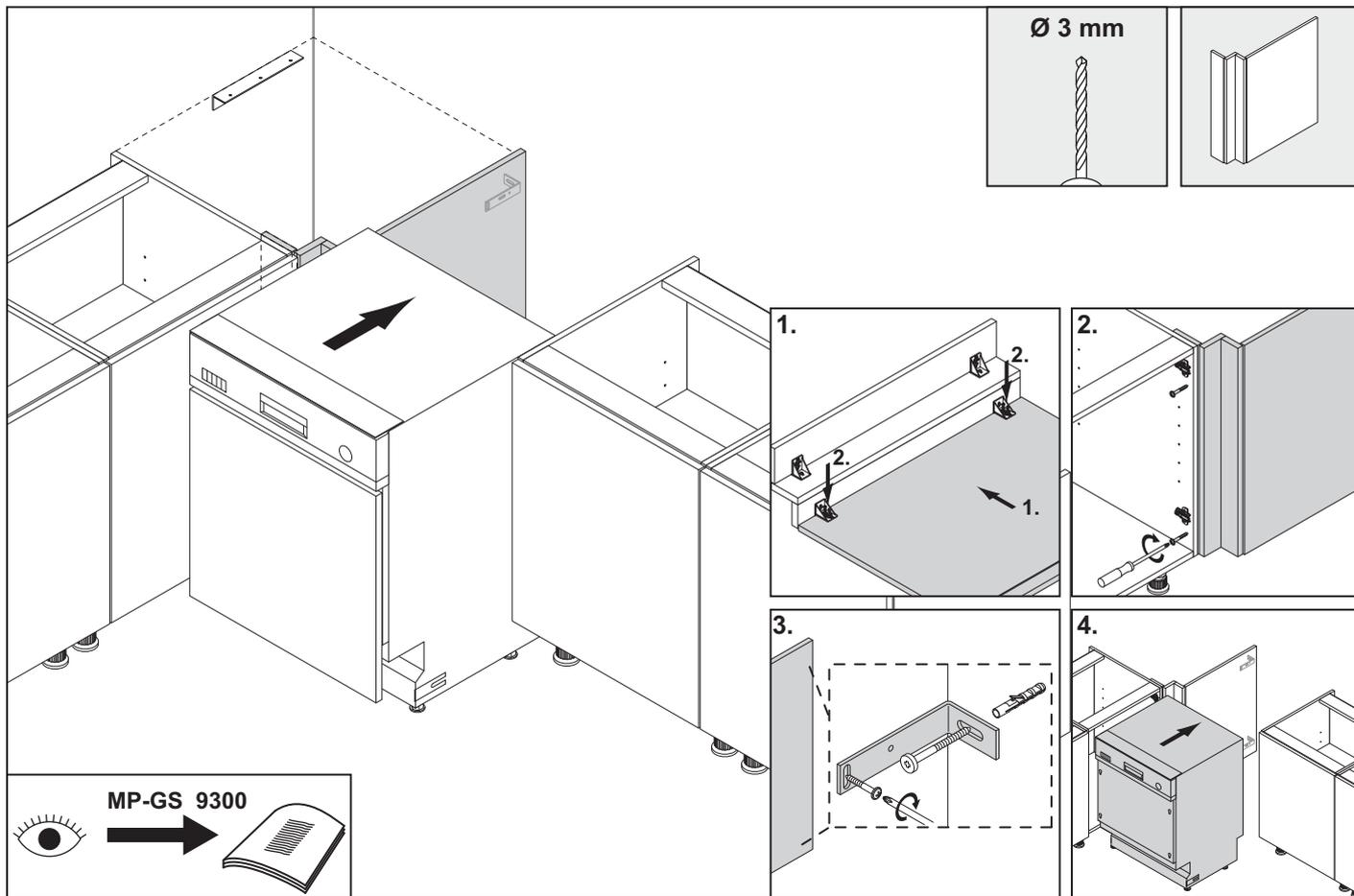
**DE** - Frontpasstück / **FR** - Fileur de façade / **NL** - Frontpasstuk / **EN** - Front Corner Post / **ES** - Pieza de ajuste del frente / **SE** - Passbit / **IT** - Fascia frontale / **HR** - Čeonog adaptera / **SI** - Čelnega kotnika / **FI** - Peitelevy
