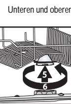
Unteren und oberen Sprüharm einsetzen und gut festziehen.
